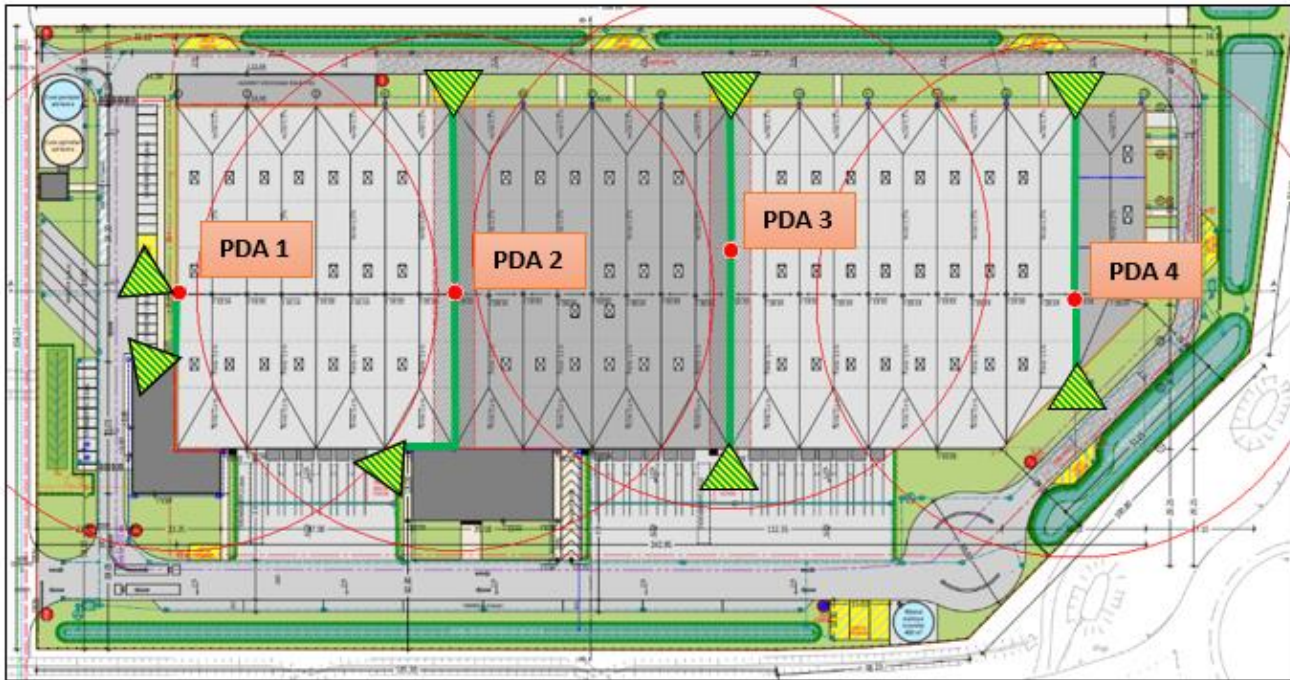
Implantation des paratonnerres à dispositif d'amorçage, conducteurs de descente et prises de terre
